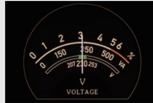
② Eingangs-/Ausgangsspannung (V)
