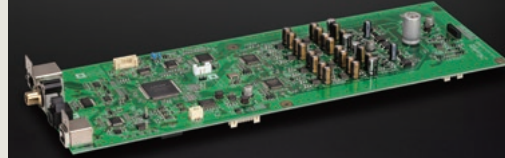
⑥ D/A Wandler mit acht parallelen Schaltungen
